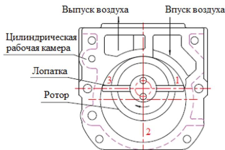
1. Расширение объема рабочей камеры, всасывание газа
