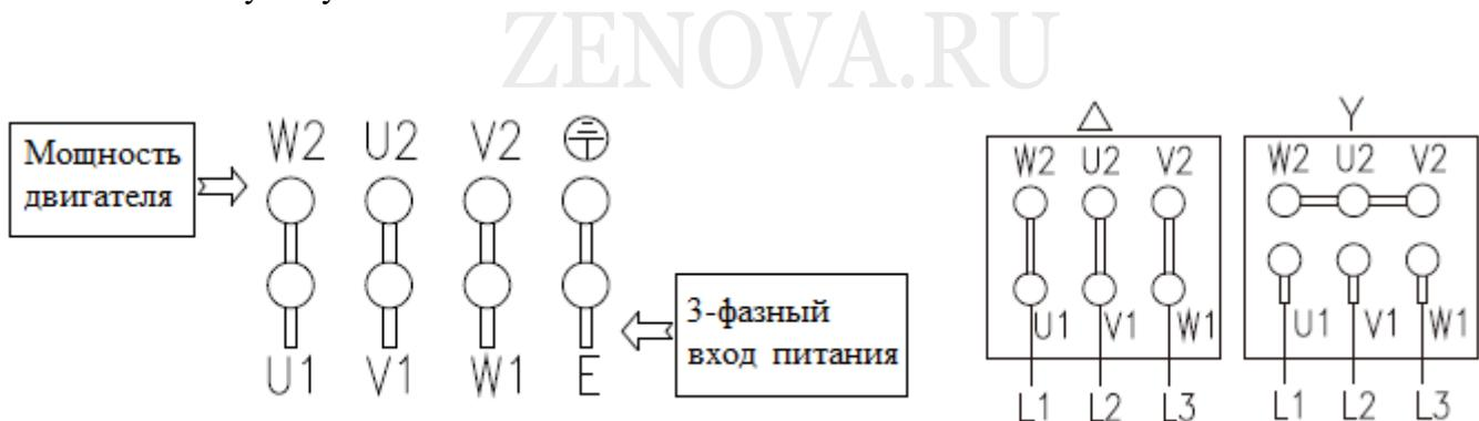
Рис. 4 – Схема подключения 3 проводов (слева) и 6 проводов (справа) трехфазного электродвигателя насосов серии VRD
