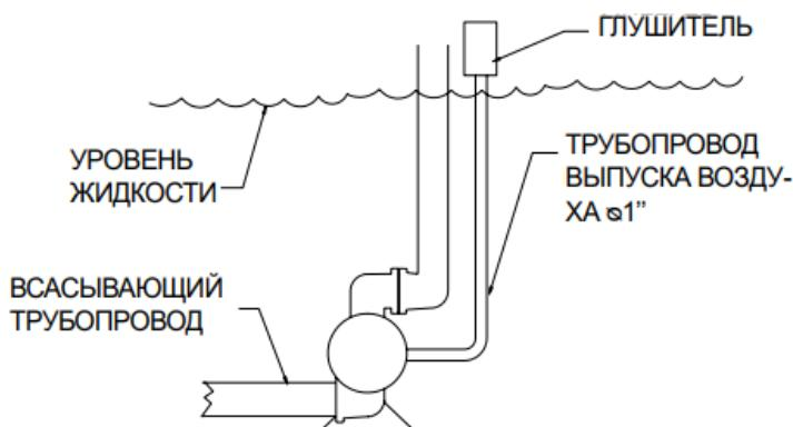
Погружное применение насоса возможно, если материалы, из которых он изготовлен, совместимы с перекачиваемой жидкостью. Труба для выпуска воздуха должна располагаться выше уровня жидкости. Если источник перекачиваемого продукта располагается выше уровня насоса (такое расположение используется при заливе всасывающей линии), для предотвращения сифонирования трубы выпуска воздуха следует установить выше уровня источника жидкости.
