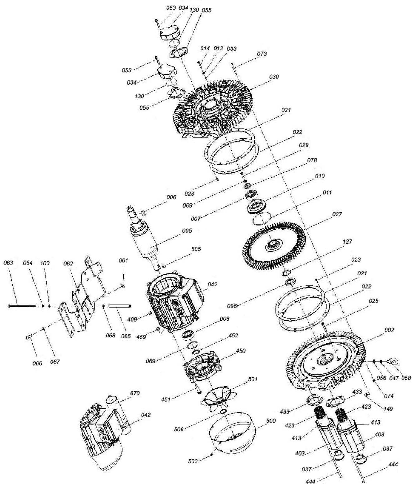
Рис. 4 – Деталировка одноступенчатых воздуходувок 4RB
