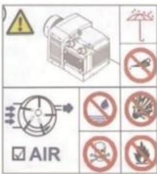
Линейка насосов Zenova BV работает без вакуумного масла. Не перекачивайте этим насосом жидкость, а также легковоспламеняющиеся и взрывоопасные газы.
