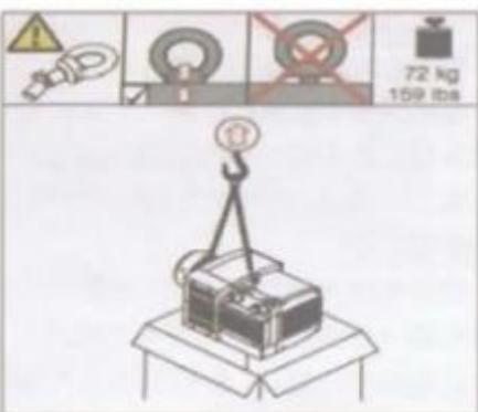
При распаковке используйте для подъема рым-болт. Рым-болт должен быть затянут, чтобы предотвратить его поломку.
