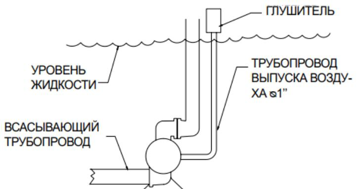
Погружное применение насоса возможно, если материалы, из которых он изготовлен, совместимы с перекачиваемой жидкостью. Труба для выпуска воздуха должна располагаться выше уровня жидкости. Если источник перекачиваемого продукта располагается выше уровня насоса (такое расположение используется при заливе всасывающей линии), для предотвращения сифонирования трубу выпуск воздуха следует установить выше уровня источника жидкости.
