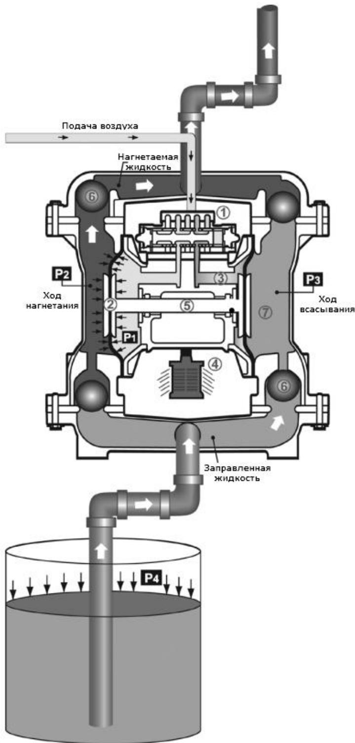
Пневмоприводные двухмембранные насосы
