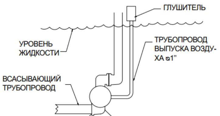
Погружное применение насоса возможно, если материалы, из которых он изготовлен, совместимы с перекачиваемой жидкостью. Труба для выпуска воздуха должна располагаться выше уровня жидкости. Если источник перекачиваемого продукта располагается выше уровня насоса (такое расположение используется при заливке всасывающей линии), для предотвращения сифонирования трубу выпуск воздуха следует установить выше уровня источника жидкости.
