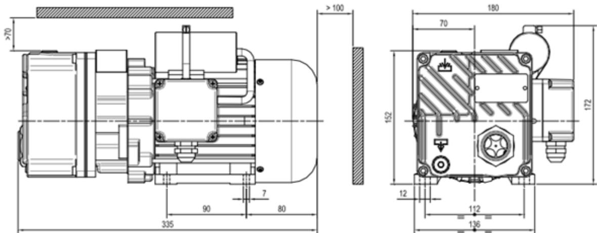
Рисунок 2. Габаритные размеры насосов серии: LB.5
