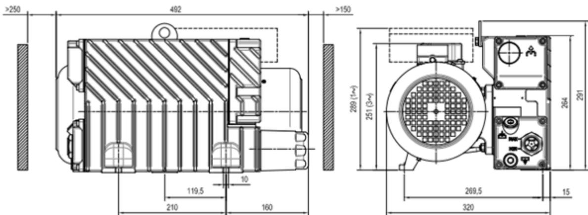
Рисунок 5. Габаритные размеры насосов серий: LB.40 – LB.60
