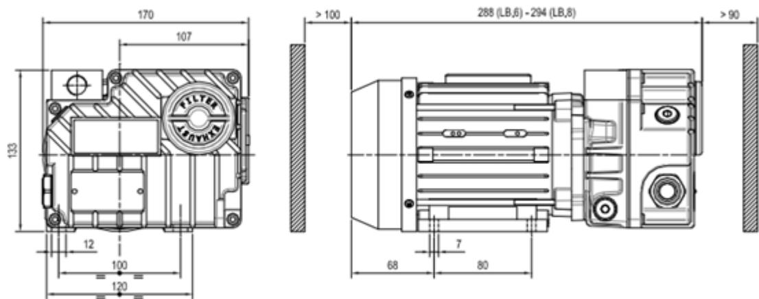
Рисунок 3. Габаритные размеры насосов серий: LB.6 – LB.8
