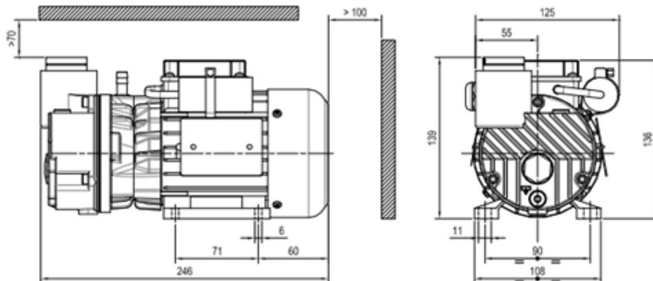
Рисунок 1. Габаритные размеры насосов серий: LB.2, LB.3, LB.4
