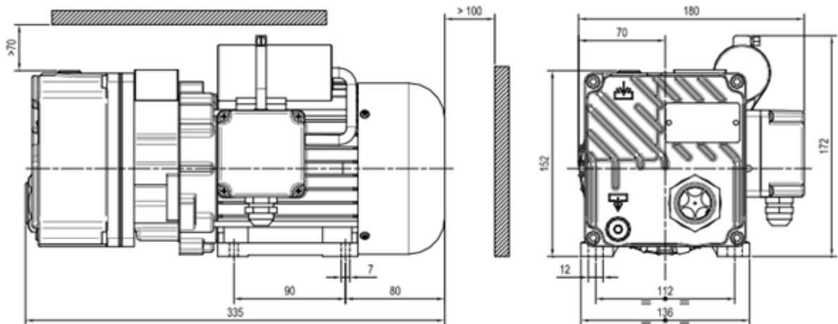
Рисунок 2. Габаритные размеры насосов серии: LB.5
