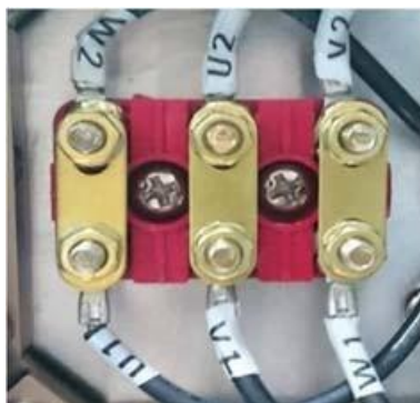
Подключение к трехфазной сети 220 В
