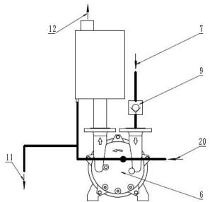
Рисунок 3: 6) корпус вакуумного насоса; 7) всасывающий патрубок; 8) электромагнитное реле; 9) обратный клапан; 10) сепаратор; 11) перепускной клапан; 12) выходной патрубок; 20) подача рабочей жидкости.
