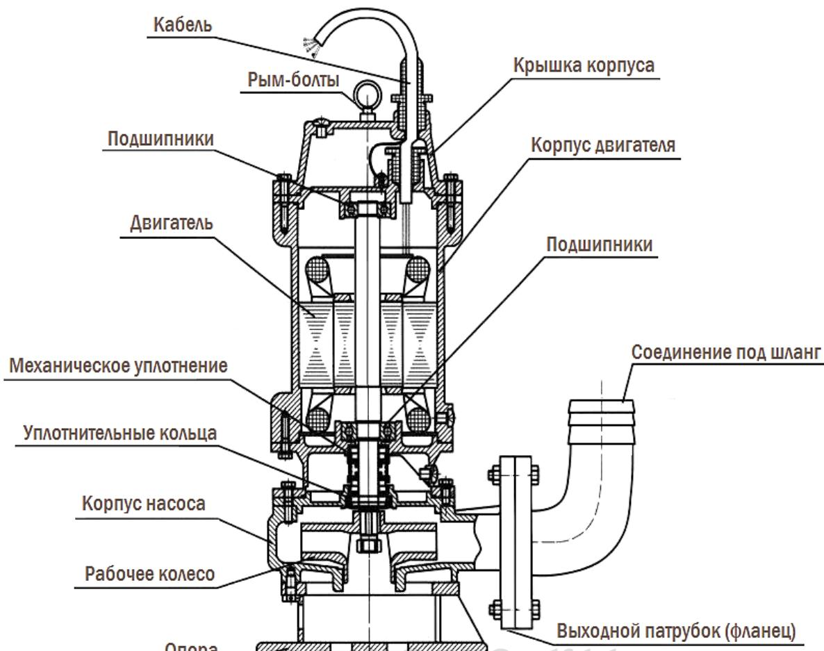
Рисунок 1. Схема конструкции насоса
