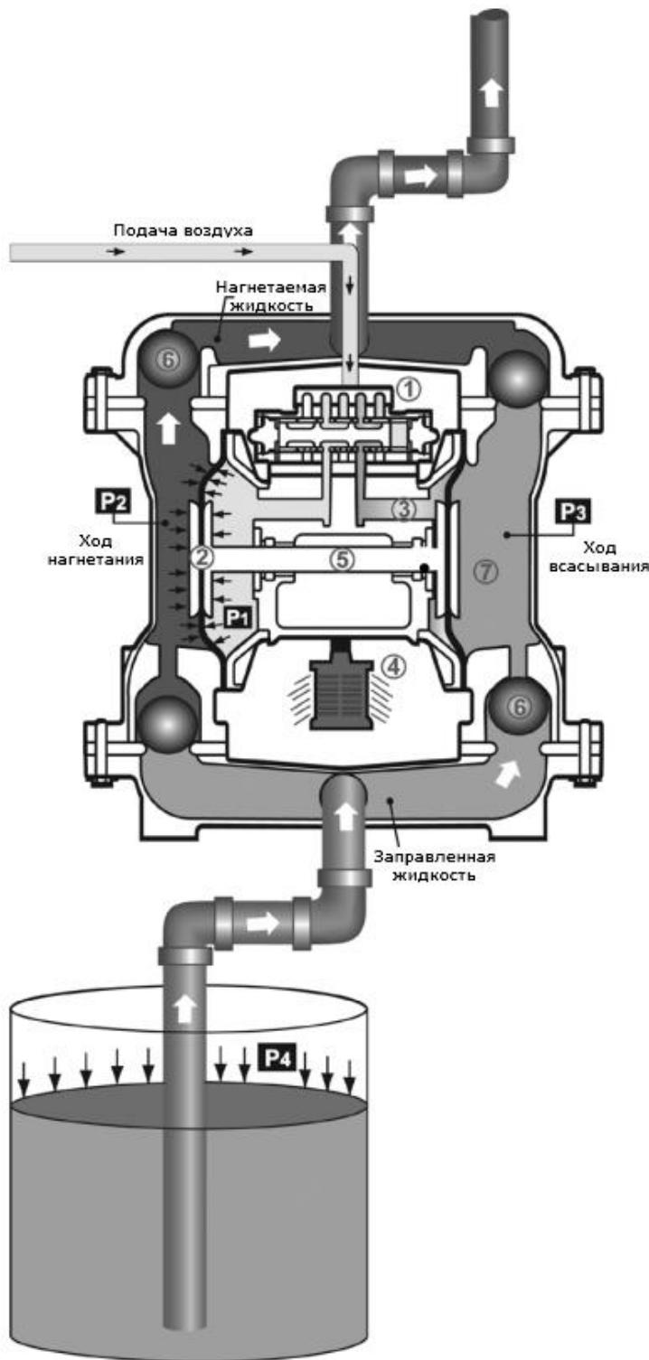
Пневмоприводные двухмембранные насосы
