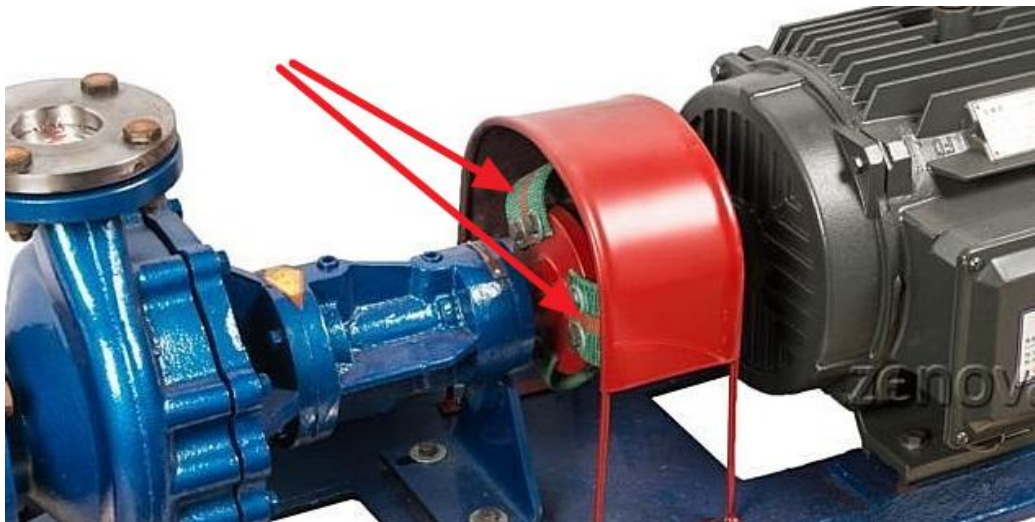
Изображение 1. В муфте двигателя насоса WRY применяются гибкие ремни.
