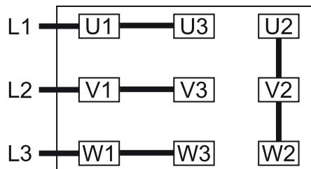
Соединение по схеме «звезда», двигатель, способный работать при различных напряжениях питания, с 9 контактами (высокое напряжение):
