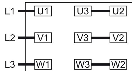
Соединение по схеме «двойная звезда», двигатель, способный работать при различных напряжениях питания, с 12 контактами (низкое напряжение):
