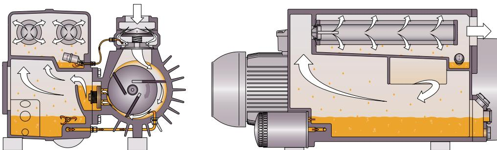
Принцип работы машины — роторно-лопастной.
