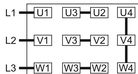
Соединение по схеме «треугольник», двигатель, способный работать при различных напряжениях питания, с 12 контактами (среднее напряжение):
