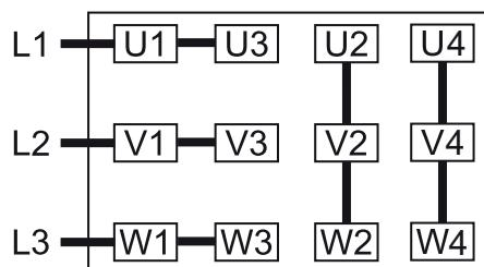
Соединение по схеме «звезда», двигатель, способный работать при различных напряжениях питания, с 12 контактами (высокое напряжение):
