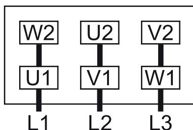
Соединение по схеме «звезда» (высокое напряжение):
