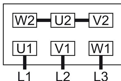
Соединение по схеме «двойная звезда», двигатель, способный работать при различных напряжениях питания, с 9 контактами (низкое напряжение):
